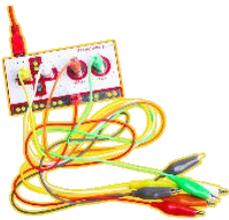
**Makey Makey** est un circuit imprimé, qui permet de contrôler des objets du quotidien comme s'ils devenaient des télécommandes. L'ajout d'objets conducteurs reliés à Makey Makey envoie un signal à l'ordinateur grâce à Scratch, ou à un autre logiciel, qui réagit avec la fonction que vous avez définie. Cette carte est aussi stimulante pour un apprenant débutant ou un expert qui veut explorer différents domaines autant en arts qu'en ingénierie.
